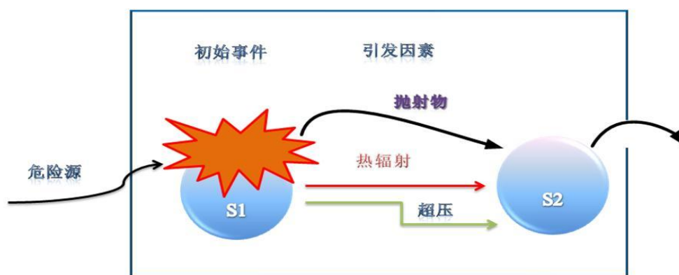
图 4.12-4 多米诺效应系统图
